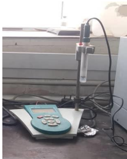
بی اچ متر: جهت تنظیم pH محلولها در محدوده ۰ تا ۱۲
